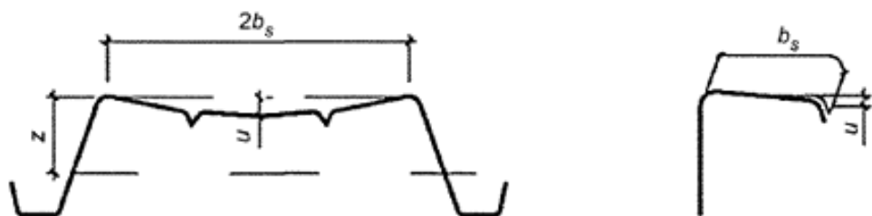
Նկար 9. Մինչև բեռնման գործադրումը ուղղագիծ տրամատի կորության օրինակ
